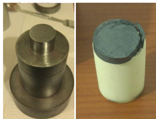
Fig. 2. a. Die set, b. CuO PLD target
