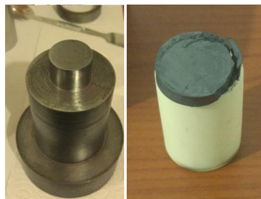
Fig. 2. a. Die set, b. CuO PLD target
